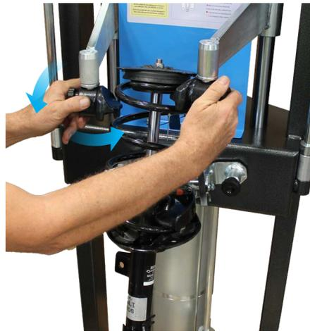
**TERMINALES FLOTANTES**, para un mejor agarre en el muelle, con adaptación dinámica incluso durante las diferentes fases de compresión
