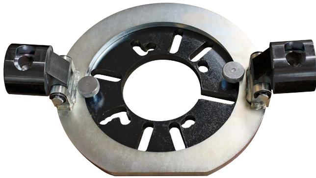
El soporte le permite comprimir los muelles de los amortiguadores del automóvil operando directamente desde el soporte superior del amortiguador.
