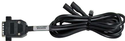
Cableado de emulación, con función de simulador digital de resistencia variable desde unos 100Ω hasta unos 25.000Ω para simulación de sensores (sensor de temperatura del motor, etc...).
