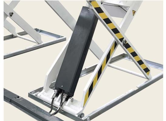
SINCRONIZACIÓN HIDRÁULICA DE LAS PLATAFORMAS
