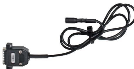
Cableado de adquisición, con la función de verificar el correcto estado de la masa tanto mecánica (carrocería) como electrónica (componentes), con visualización del resultado de la prueba.
