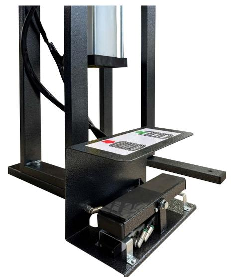
EL PEDAL DE CONTROL SOLO FUNCIONA CUANDO LA MÁQUINA ESTÁ CONECTADA AL SISTEMA DE AIRE COMPRIMIDO
