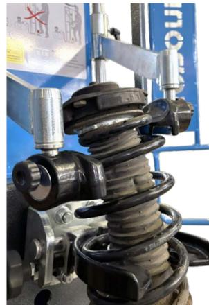
**ABRAZADERAS FLOTANTES** permiten un mejor agarre del resorte, adaptándose dinámicamente durante las diferentes fases de compresión.
