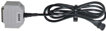
Cableado de adquisición, con la función de detectar las señales de componentes inductivos con solo el contacto del sensor de detección y la visualización de la frecuencia de operación.
