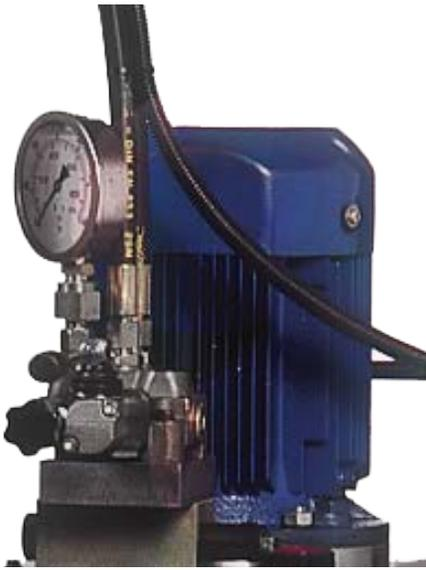
**REGULADOR DE PRESIÓN MÁXIMA Y CONTROL HIDRÁULICO MANUAL DE SUBIDA/BAJADA**
