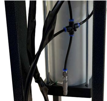
EL CILINDRO DE ALEACIÓN LIGERA DE ALUMINIO, RESINA DE NYLON Y FIBRA DE VIDRIO evita la corrosión y la oxidación de las partes internas de la máquina
