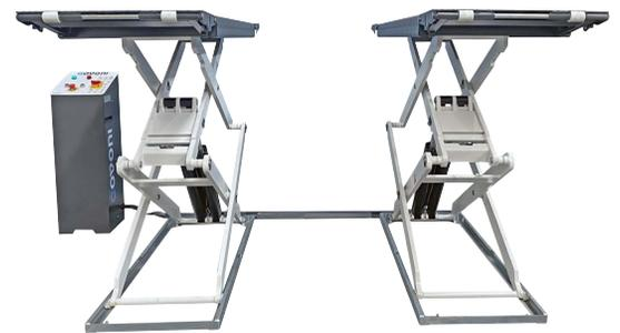
**SINCRONIZACIÓN HIDRÁULICA DE LAS PLATAFORMAS**
