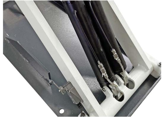
AUTONIVELACIÓN HIDRÁULICO Y SINCRONISMO DE LAS PLATAFORMAS
