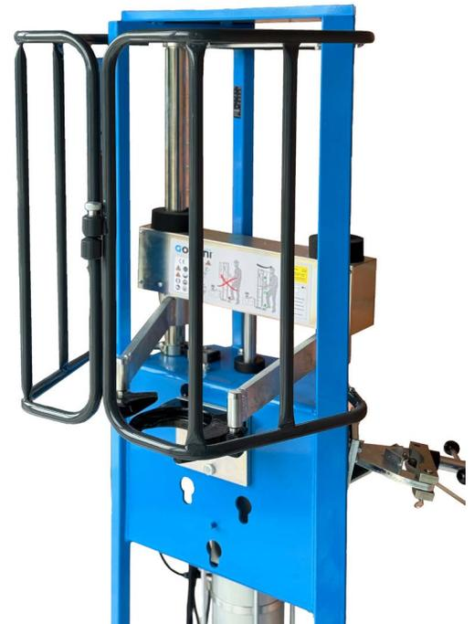
**EN EL CASO DE LA PROTECCIÓN ABIERTA, LA MÁQUINA ESTÁ EQUIPADA CON UNA VÁLVULA DE ENCLAVAMIENTO QUE IMPIDE EL FUNCIONAMIENTO**
