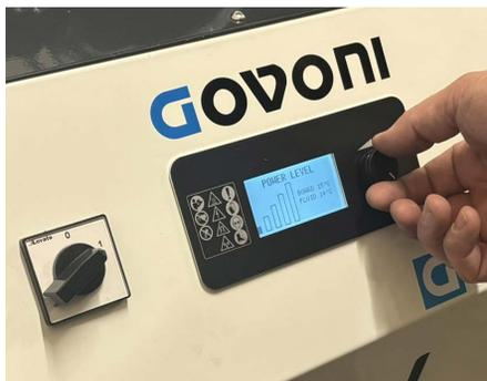
**AJUSTE DEL NIVEL DE POTENCIA (kW)**
